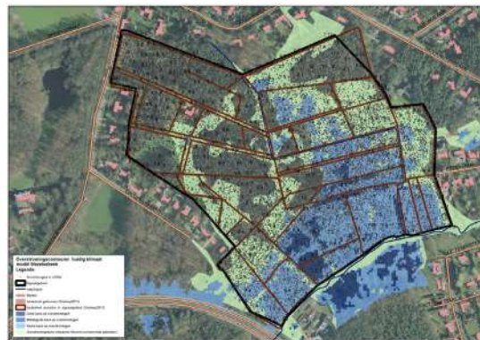
De blauwe contouren geven de huidige overstromingskans weer. Hoe donkerder blauw, hoe groter de overstromingskans. De groene contour geeft de recente overstromde gebieden (ROG) weer, waar geen specifieke overstromingskans gekend is.
